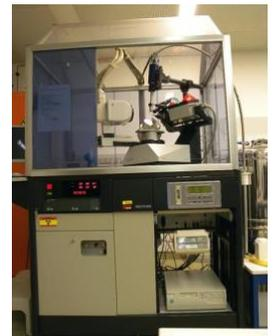
Abb.: Nonius Kappa Röntgen-Einkristall-Diffraktometer der Uni Wien
